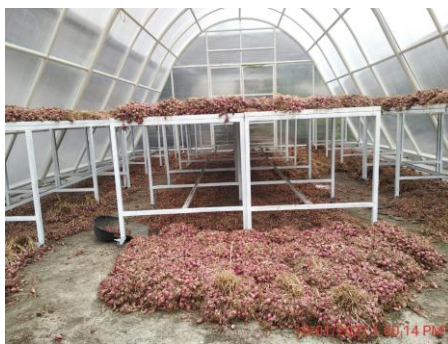
Gambar 3.7 Solar Dryer untuk mempercepat pengeringan bawang merah;
